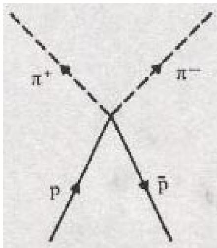
Muestra las líneas del mundo del protón ( $p$ ) y del antiprotón ( $\bar{p}$ ) que colisionan en un punto del espacio y del tiempo, aniquilándose uno a otro y creando dos piones ( $\pi^+$  y  $\pi^-$ ). Este diagrama, no obstante, no da una representación completa. La interacción entre el protón y el antiprotón puede ser representada como el intercambio de un neutrón virtual, como nos muestra el siguiente diagrama.
