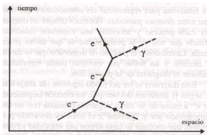
Este diagrama se lee del modo siguiente (de abajo a arriba, según la dirección del tiempo): un electrón (representado por  $e^-$  a causa de su carga negativa) colisiona con un fotón (representado por  $\gamma$ , "gamma"); el fotón es absorbido por el electrón, que continúa su camino con una velocidad ya distinta (diferente inclinación de la línea del mundo); después de un momento, el electrón emite de nuevo el fotón e invierte la dirección de su movimiento.
