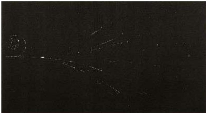
La siguiente fotografía muestra un claro ejemplo de tal colisión: un protón entra en la cámara de burbujas por la izquierda, desprende (por colisión) un electrón de un átomo (rastro espiral) y después colisiona con otro protón, creándose en esta colisión dieciséis nuevas partículas.
