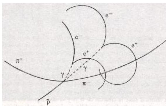
Una secuencia de sucesos en la que ocurren dos creaciones: un antiprotón ( $\bar{p}$ ) llegando desde abajo colisiona con un protón de la cámara de burbujas, creando un  $\pi^+$  (que sale proyectado hacia la izquierda), un  $\pi^-$  (que surge hacia la derecha) y dos fotones ( $\gamma$ ), cada uno de los cuales crea un par electrón-positrón. Los positrones ( $e^+$ ) se curvan hacia la derecha, los electrones ( $e^-$ ) hacia la izquierda.
